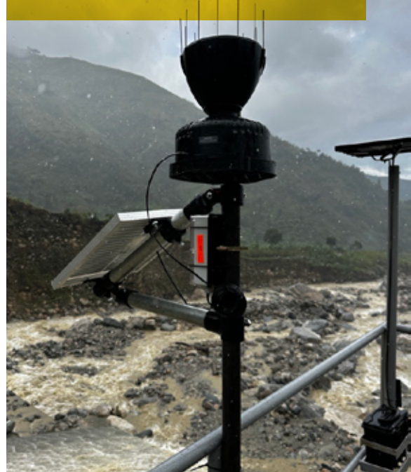
De WIM (Weather Integrated Module) meet temperatuur, luchtdruk, vochtigheid en neerslag.
